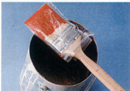
Банка с проволочной ручкой — удобная ёмкость для работы кистью и очистки последней.
