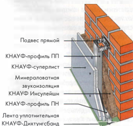
Конструкция облицовки С 663
