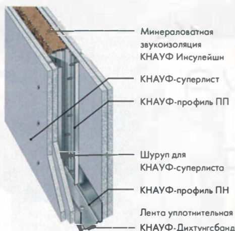
Конструкция перегородки С 362
